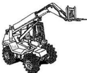
**Gru mobile:** autogrù a braccio in grado di spostarsi con carico o senza carico senza bisogno di vie di corsa fisse e che rimane stabile per effetto della gravità.
