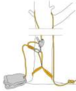
Fig. 7 - Ancoraggio svincolabile della fune alla base dell'albero
