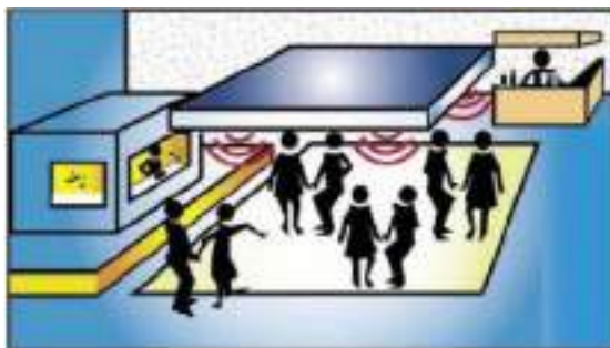
Figura 2. Discoteca con soffitto recante diversi altoparlanti in sostituzione di sistemi di amplificazione a terra
