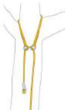
Fig. 8 - Ancoraggio passante per corda raddoppiata
